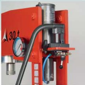
BKN-09: Bomba de funcionamiento neumático y manual. El comando neumático se acciona manualmente.
