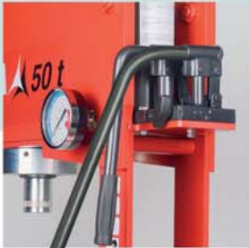
BKD-09: Bomba de 2 velocidades. Para modelos KPD.
